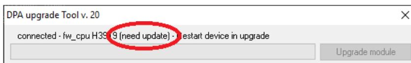
4.- EKSEL compact Plus se debe poner en "upgrade mode" si se requiere una actualización. Para ello enchufar EKSEL compact Plus manteniendo apretada la tecla ENTER.
